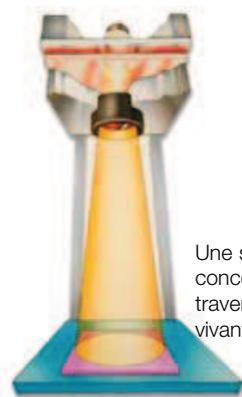
Une source lumineuse concentrée est projetée à travers une veine d'huile vivante.
