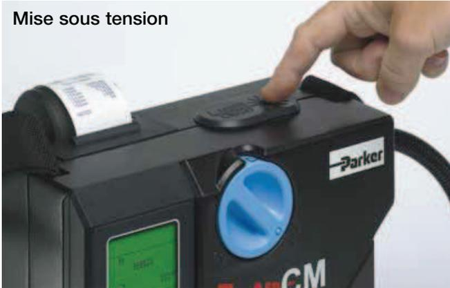
Le compteur icountLaserCM de Parker fonctionne de manière on ne peut plus simple en pressant le bouton de mise sous tension et en tournant le bouton de la valve. La procédure de test est automatique et ne prend, dans le cas du icountLaserCM, que 2 minutes.
