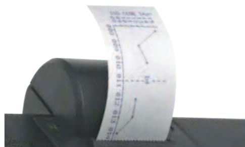
Imprimante 16 colonnes pour sortie sur papier. L'une des caractéristiques du icountLaserCM est son option graphe de données sur imprimante intégrée, développée pour supporter les procédures de maintenance prédictives.
